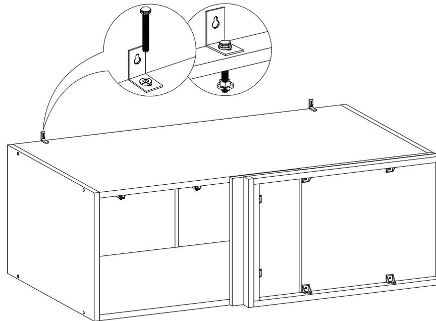
**ВНИМАНИЕ!** При установке антресоли **НА** другой модуль происходит замена навесов. На антресоль устанавливаются угловые навесы из комплекта фурнитуры того модуля, на который происходит установка. Регулируемые навесы «краб» из комплекта фурнитуры антресоли устанавливаются на тот модуль, который находится ниже.
