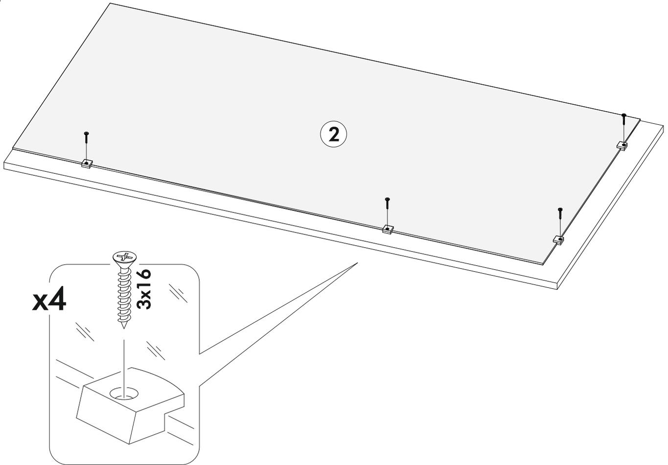
**Внимание!** Монтаж зеркал/стекол к фасадам производится самостоятельно на двусторонний скотч и/или клэймеры **ОБЯЗАТЕЛЬНО** для крепления необходимо использовать монтажный клей «жидкие гвозди»
