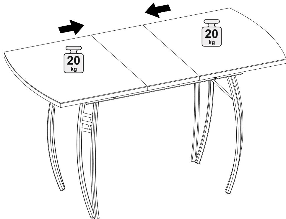
**Внимание!** Во внутренней части подстоля находятся **ДВА** фиксатора, которые фиксируют столешницу в разложенном или сложенном состоянии
